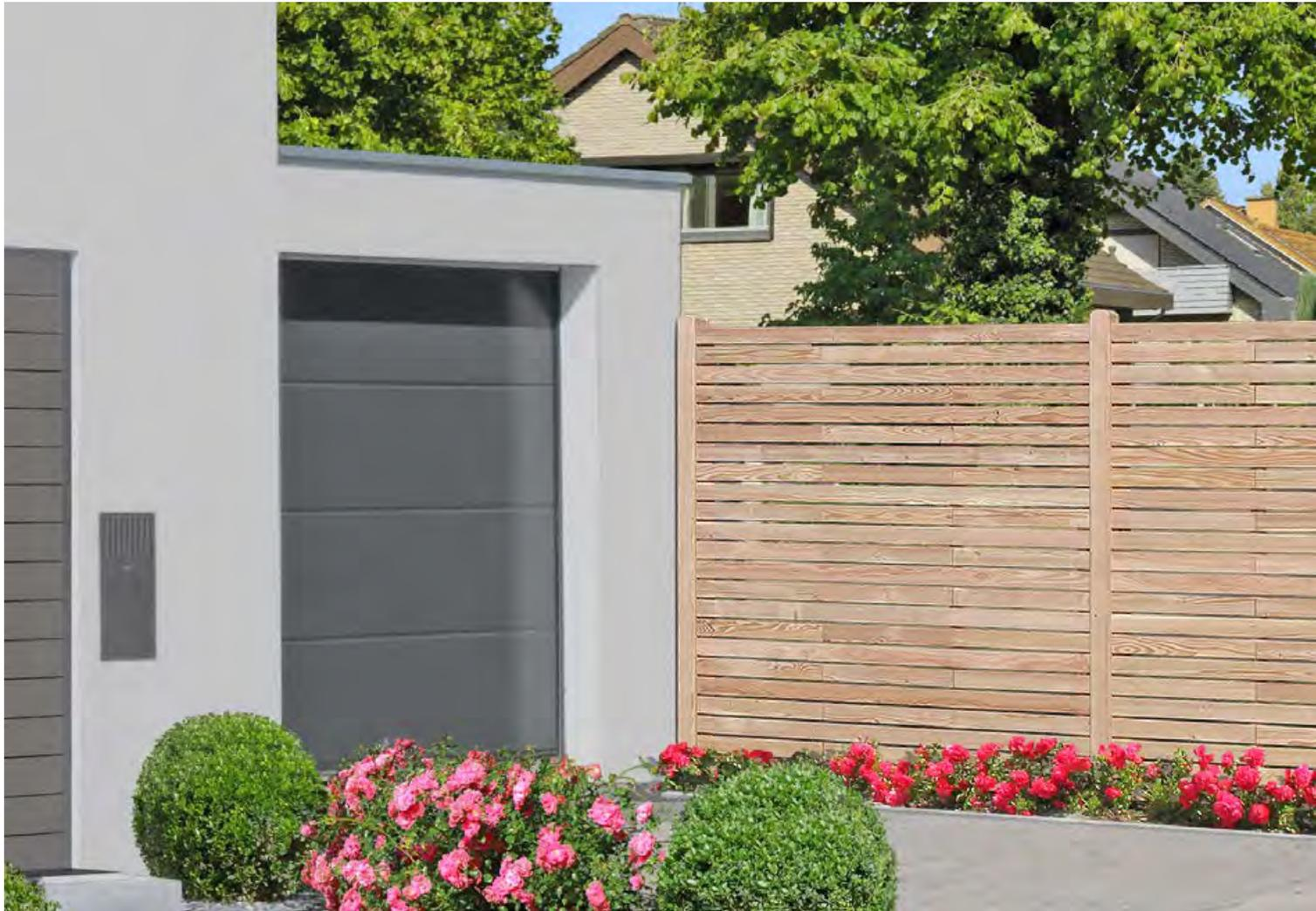
Gestalterische Aufmerksamkeit erzeugen die VALENTINA Elemente durch ein eindrucksvolles Wechselspiel der langen und kurzen Lärchenholzprofile. Die schlanken ca. 8 mm Längsfugen geben den Sichtblenden eine Leichtigkeit. Von Natur aus ist VALENTINA jedem Wetter gewachsen, weil eigene Inhaltsstoffe das edle Holz schützen. Seit Jahrzehnten wird die Lärche Outdoor eingesetzt.
