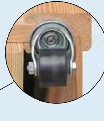
Diese Lenkrolle\* hat ein Kugellager und hohe Tragkraft. Sie ist mit einer Edelstahlschraube befestigt. Damit das Holz nicht spleißt, wurde das Loch für die Schraube vorgebohrt.
