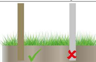
Graue Pfosten nur mit Pfostenankern befestigen. Es gibt für alle Befestigungen die passende Lösung. Sprechen Sie Ihren Fachhändler an.
